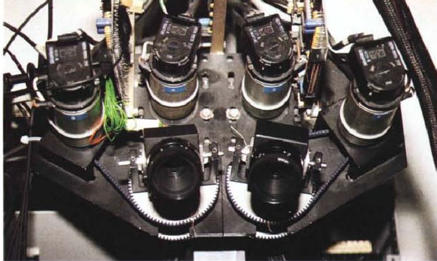
È visibile il sistema di movimentazione delle ottiche, dell'apparato di visione artificiale studiato all'ARTS Lab di Pisa; anche questo è basato sul sensore retinico CCD.
